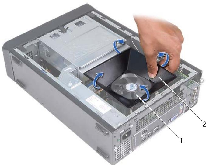
1 conjunto da ventoinha e dissipador de calor do processador
